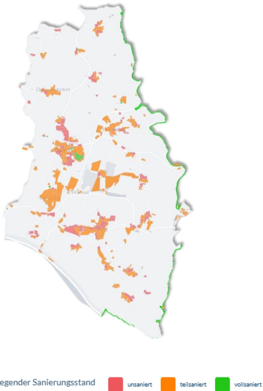
Abbildung 41: Darstellung Sanierungsstand IST-Zustand
