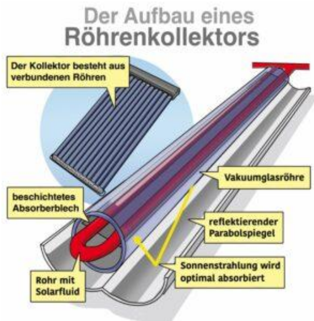
Abbildung 28: Aufbau eines Röhrenkollektors
